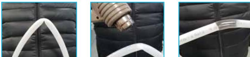
Las tuberías SharkBite PEXa debido a su excelente Memoria Térmica absorbe el aumento de tamaño debido a la congelación. La reticulación por el sistema PEXa ( método peróxido ), permite que se expanda ( por el aumento de volumen debido a la congelación ) y absorba gran parte de la energía de expansión del proceso de congelación. Ninguna tubería es completamente inmune a la congelación, pero la tubería SharkBite PEXa de RWC es extremadamente resistente a daños de congelamiento.
