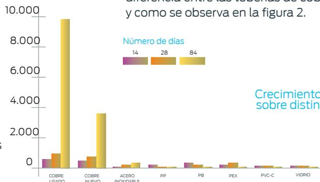
**Resultado:** Los materiales plásticos han obtenido valores similares a los del vidrio, que es el material de referencia. El cobre ha obtenido aquí valores muy elevados. La incidencia de la corrosión en un mayor crecimiento de bacterias, explica la diferencia entre las tuberías de cobre nuevo y cobre usado, tal y como se observa en la figura 2.
