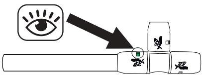
Introducir el extremo del tubo biselado en el accesorio hasta comprobar visualmente el anillo verde de comprobación visual. El esfuerzo a realizar es mínimo debido a la incorporación de grasa siliconada en cada accesorio.
