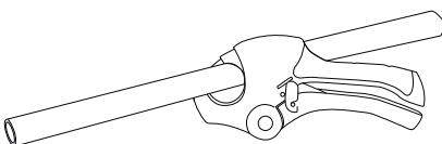
Cortar el tubo a 90°. Es fundamental para realizar un buen biselado
