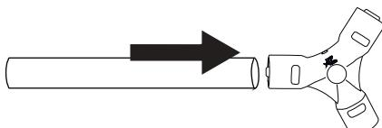
Calibrar y biselar el extremo del tubo cortado. Comprobar que se ha biselado correctamente el interior y el exterior del tubo.
