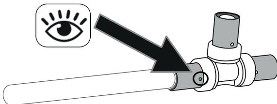
4. Prensar, siguiendo las instrucciones del fabricante de la herramienta. Para un correcto prensado, es necesario que la herramienta cumpla con el mantenimiento exigido por el fabricante.
