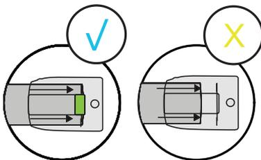
Comprobar que el tubo está fijado al accesorio [SharkBite NEXUS](#) tirando en sentido contrario al accesorio con el objetivo de asegurarse que la pinza se ha anclado al tubo.
