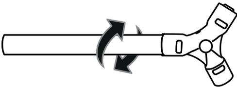
3. Introducir el extremo del tubo biselado en el accesorio [SharkBite NEXUS](#). **El indicador de seguridad visual verde nos indicará que la unión ha quedado correcta y segura.**
