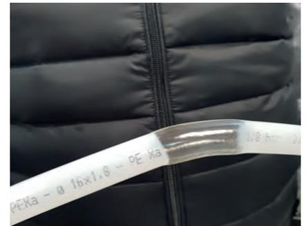
Las tuberías **SharkBite PEXa** debido a su excelente memoria térmica absorben el aumento de tamaño debido a la congelación. La reticulación por el sistema PEXa (método peróxido), permite que se expanda (por el aumento de volumen debido a la congelación) y absorba gran parte de la energía de expansión del proceso de congelación. Ninguna tubería es completamente inmune a la congelación, pero la tubería **SharkBite PEXa** de RWC es extremadamente resistente a daños de congelamiento.
