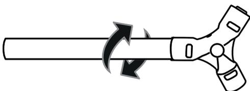
3. Introducir el extremo del tubo biselado en el accesorio, hasta comprobar que el tubo sobrepasa el orificio de comprobación visual.
