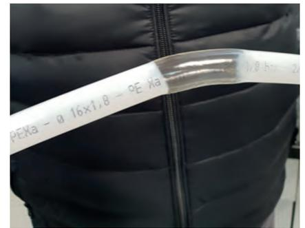
Las tuberías SharkBite PEXa EVOH debido a su excelente memoria térmica absorben el aumento de tamaño debido a la congelación. La reticulación por el sistema PEXa (método peróxido), permite que se expanda (por el aumento de volumen debido a la congelación) y absorba gran parte de la energía de expansión del proceso de congelación. Ninguna tubería es completamente inmune a la congelación, pero la tubería SharkBite PEXa EVOH de RWC es extremadamente resistente a daños de congelamiento.
