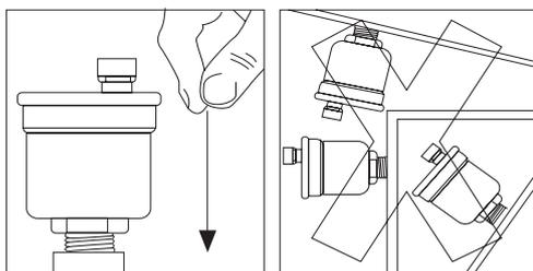
Los purgadores automáticos deberán ser instalados en posición vertical.
