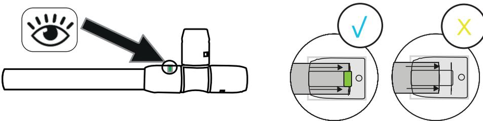
4. Comprobar que el tubo está fijado al accesorio [SharkBite NEXUS](#) tirando en sentido contrario al accesorio con el objetivo de asegurarse que la pinza se ha anclado al tubo.
