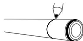
4 - Marcar el tubo con el "Pipe Liner" insertado
