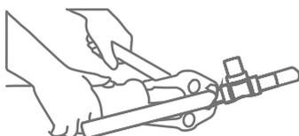
4 - Prensar, siguiendo las instrucciones del fabricante de la herramienta. Para un correcto prensado, es necesario que la herramienta cumpla con el mantenimiento exigido por el fabricante
